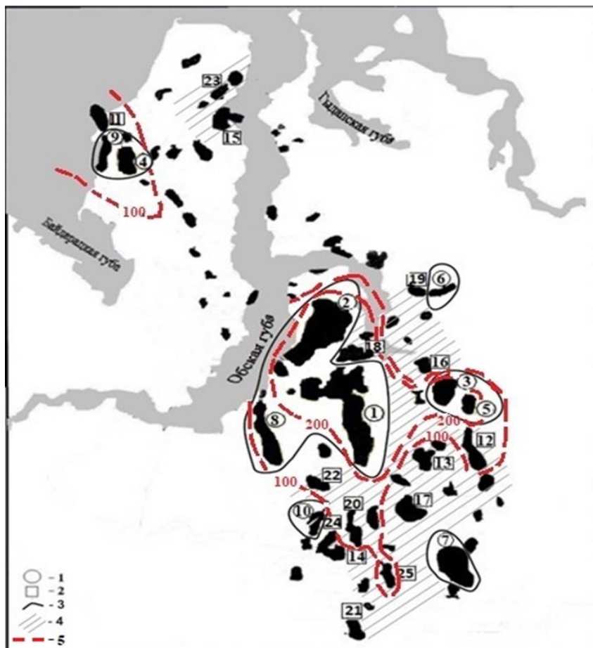
Рисунок 1. Схема размещения углеводородных скоплений с разной категорией запасов УВ в верхнем продуктивном комплексе
